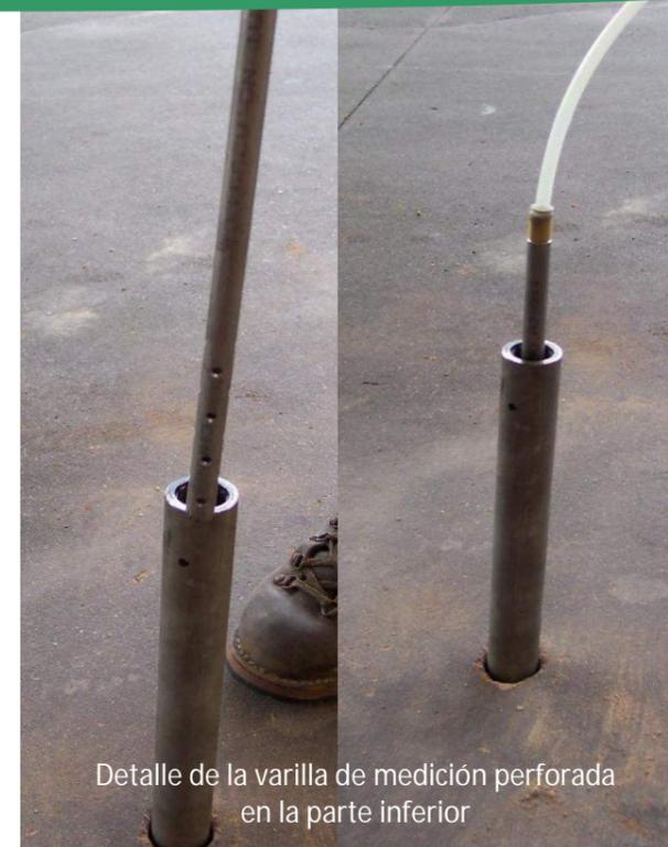
Detalle de la varilla de medición perforada en la parte inferior
