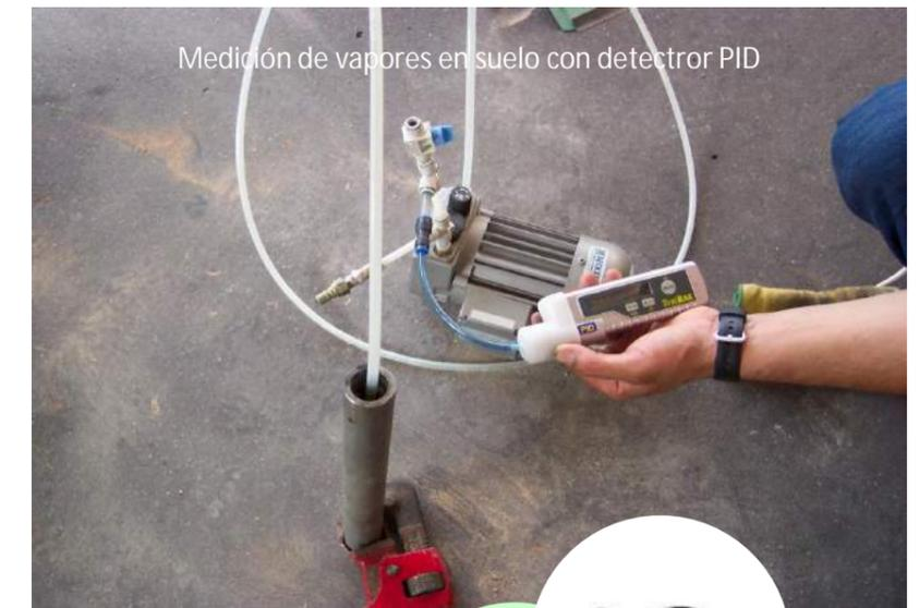
Medición de vapores en suelo con detector PID
