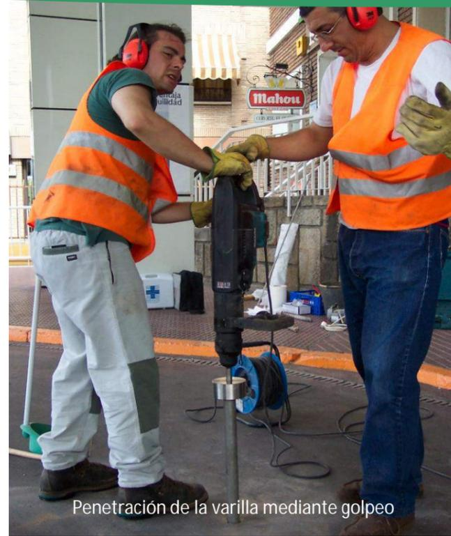
Penetración de la varilla mediante golpeo
